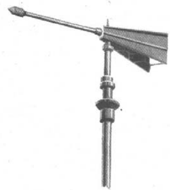
เครื่องวัดทิศทางลม
